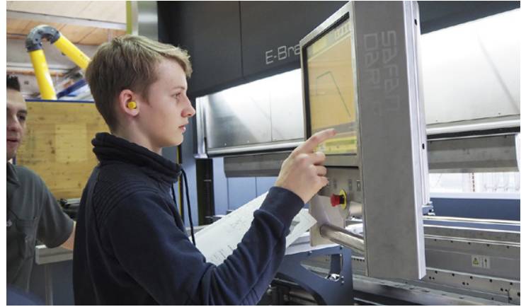
Besuch bei Safos AG, Metallbau: Nino Meile beim Eingeben der Daten am PC für die Abkantpresse. (Fotos yz)
